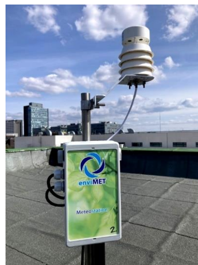
Zleva: Prachoměrná senzorní jednotka enviDUST, prachoměr Fidas 200 certifikovaný dle EN16450, senzorní meteostanice enviMET.
