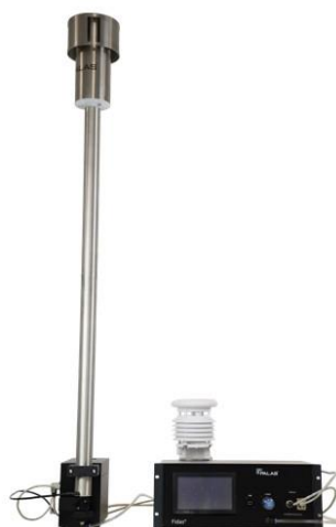
Zleva: Prachoměrná senzorní jednotka enviDUST, prachoměr Fidas 200 certifikovaný dle EN16450, senzorní meteostanice enviMET.
